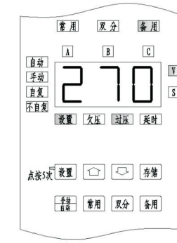
图四 进入备用电源过压参数整定时的显示状态（无关指示灯没有示意状态）
