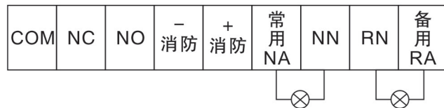
附图三 一体式3极、4极转换开关接线端
