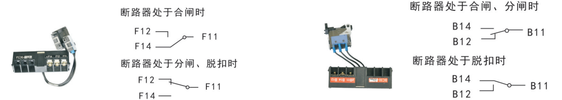
辅助触头、报警触头的技术参数
